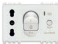
19283.B Bpresa 16 A P17/11 250 V~, 1P+N C 16 - 3 modules. Depth: 39,6 mm
