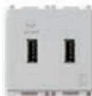
14295.SL 5 V 2,1 A, 2 USB-A for total of 2,1 A, 120-230 V~ 50/60 Hz - 2 modules. Depth: 36 mm
